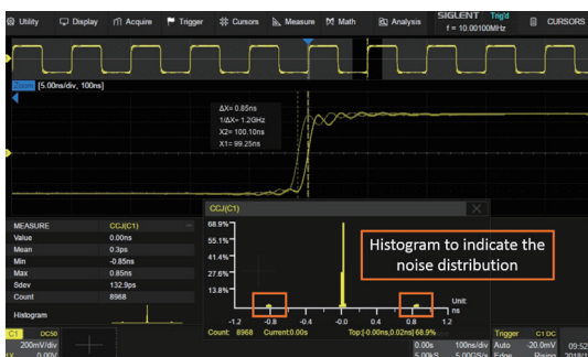
测量参数直方图显示抖动分布
